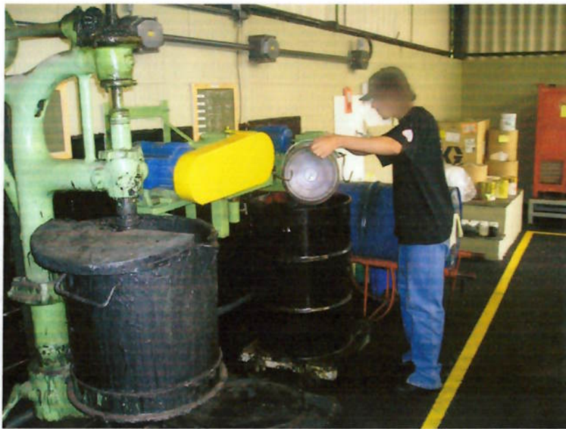
Figura 22 O solvente coletado é adicionado gradativamente à borracha em processamento no batedor.
