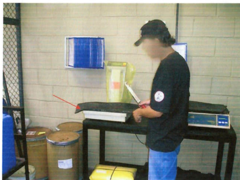
Figura 19 Manta de borracha sendo pesada conforme especificação.
