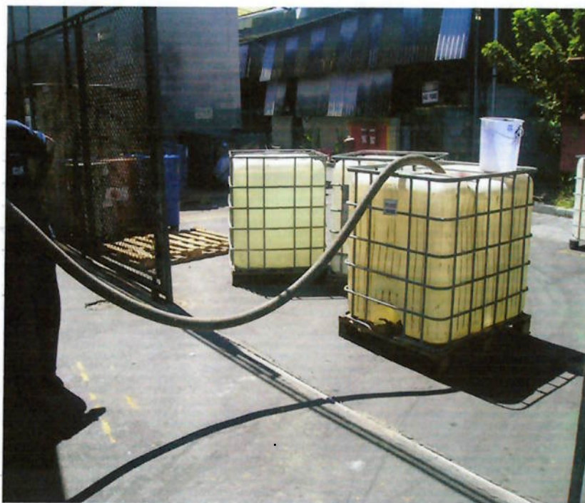
Figura 12 Solvente sendo transferido do caminhão tanque para o reservatório da empresa, através de mangueira.
