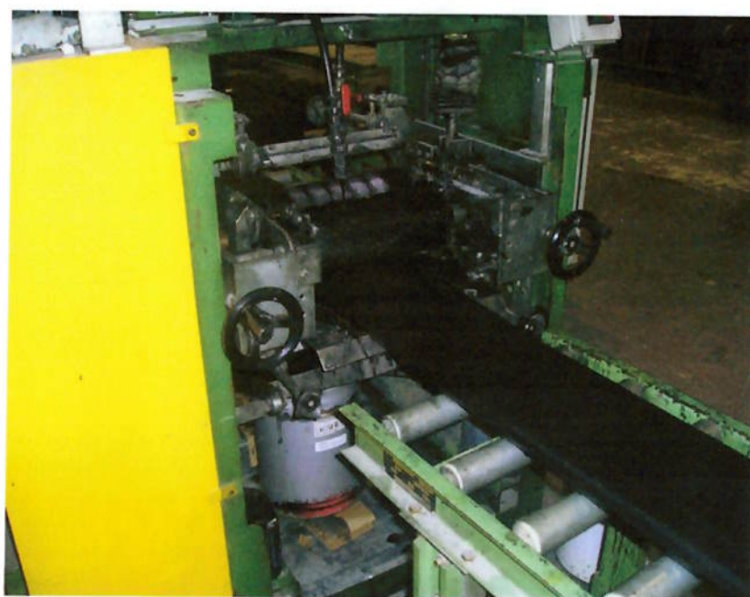
Figura 6 Aplicação de cola cimento em manta de borracha, utilizando-se rolos de transferência com regulagem de espessura da película.
