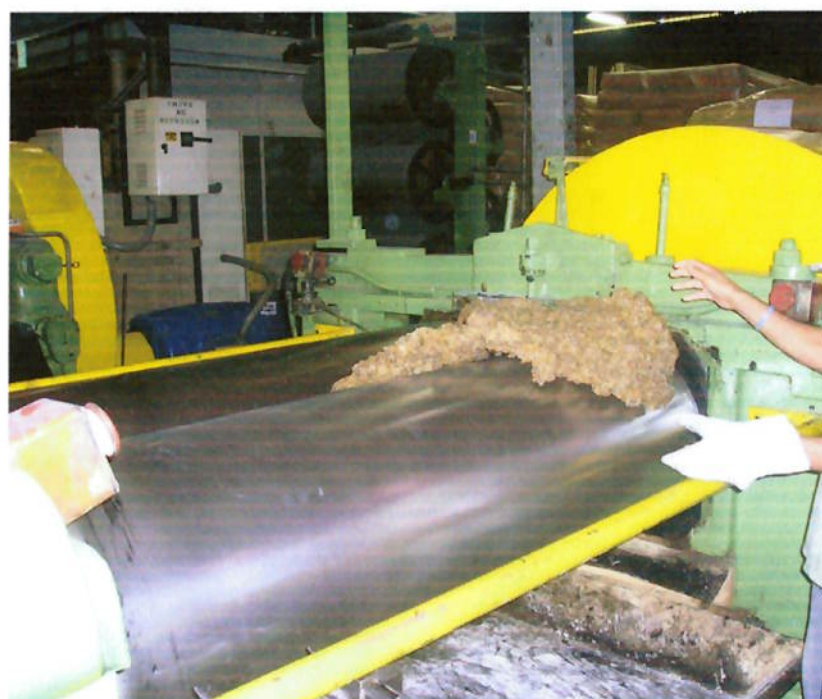
Figura 16 Borracha natural em processo de mastigamento.
