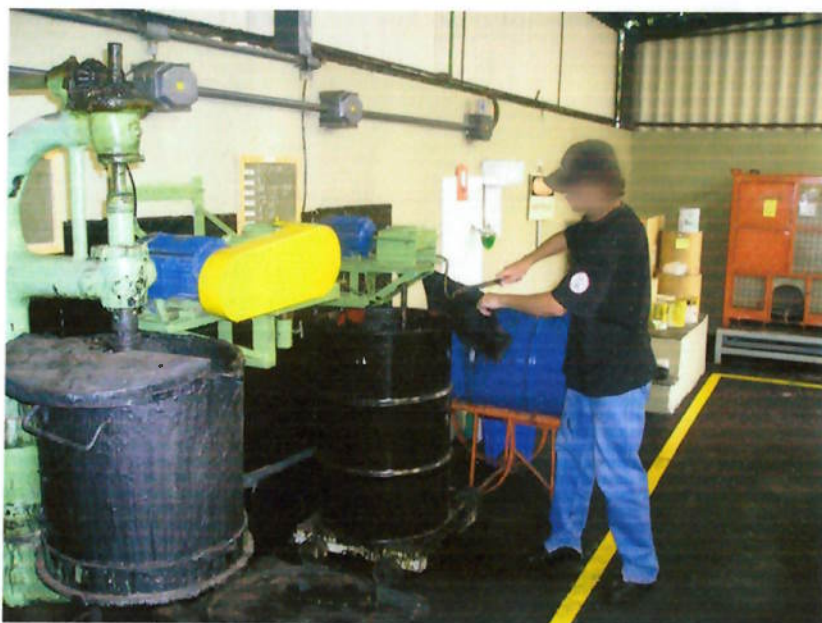
Figura 20 Manta de borracha, após pesada, é cortada em pequenos pedaço e colocada no dispositivo batedor.
