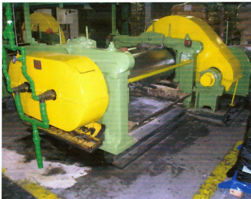
Figura 15 Cilindro misturador de dois rolos endurecidos, com rotações diferentes e com regulação de espessura das mantas de borracha produzidas.
