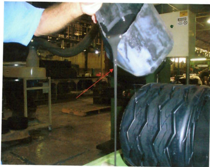
Figura 3 Cola cimento: mistura de borracha diluída por solvente, de cor escura e odor de solvente
