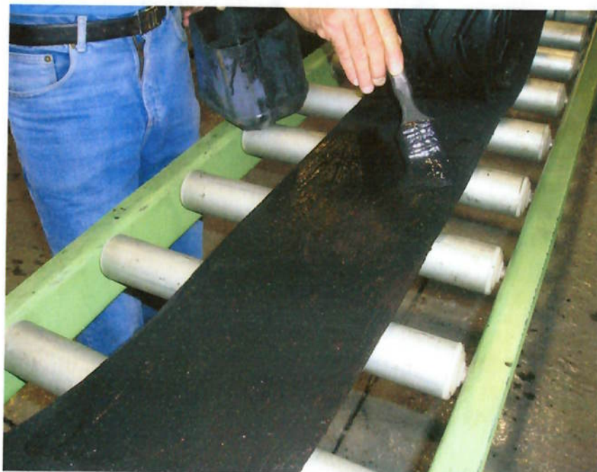
Figura 4 Funcionário aplicando com pincel cola cimento em manta de borracha utilizada em recauchutagem de pneus.
