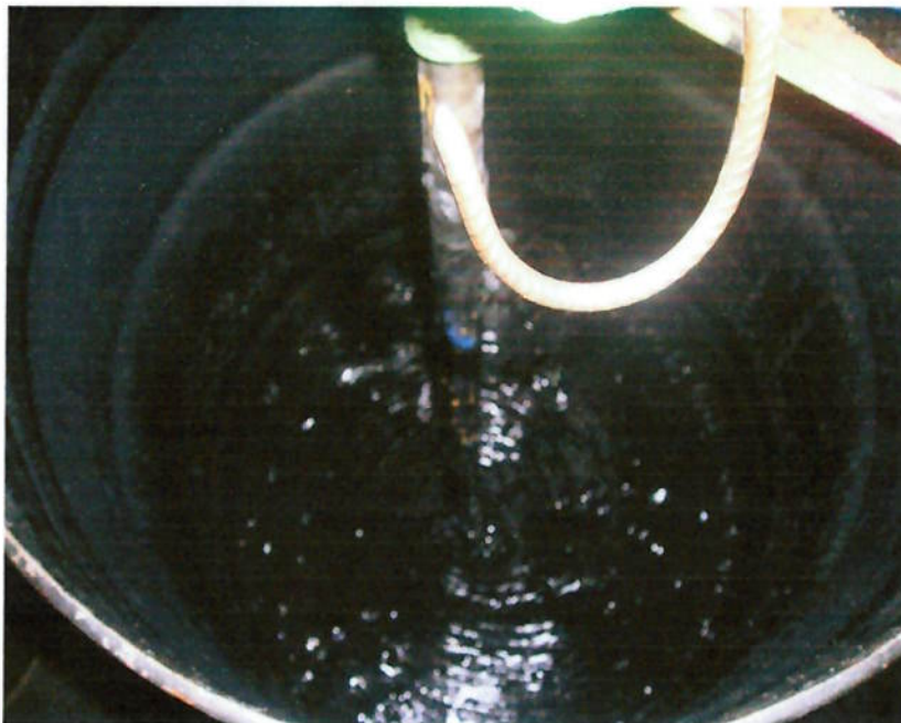
Figura 23 Homogeneização da mistura borracha e solvente, finalizando o processo de fabricação da cola cimento.
