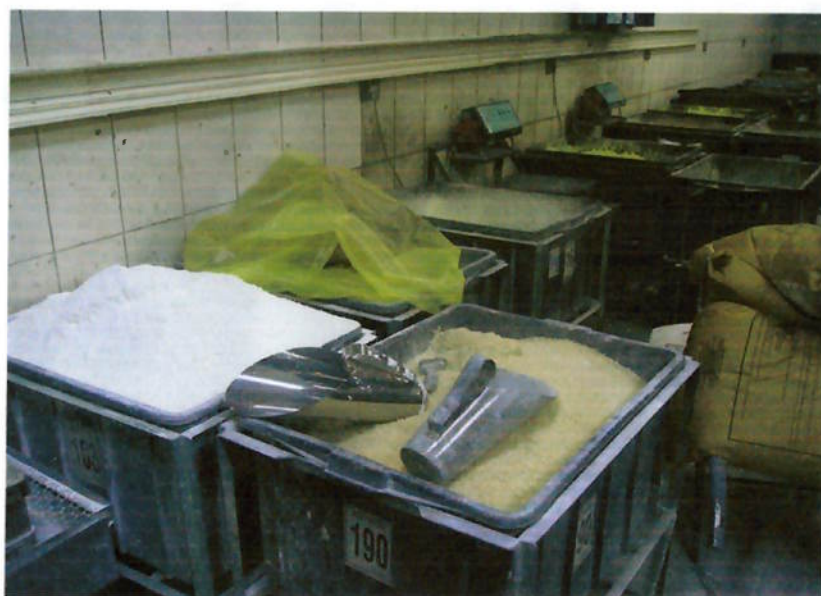
Figura 14 Componentes da formulação especificada, pesados conforme ficha de produção e embalados em sacos plásticos.
