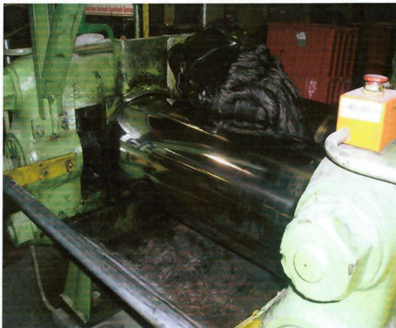
Figura 17 Após adição de todos componente a mistura de borracha fica em processo homogeneização .
