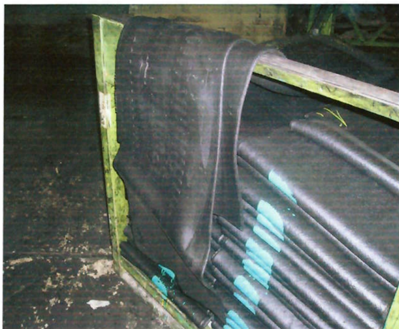
Figura 18 Após o processo de homogeneização e com a espessura de acordo com as especificações, a borracha é retirada do cilindro misturador em mantas, e acondicionada em pallets.
