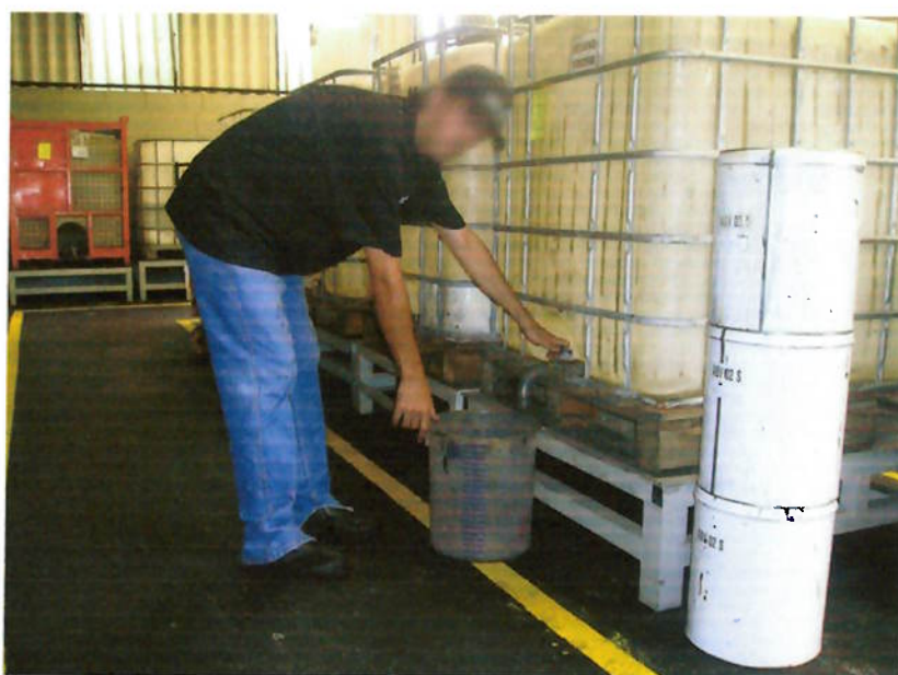
Figura 21 Solvente sendo coletado em balde plástico com graduação, de acordo com a quantidade especificada.
