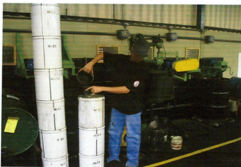
Figura 24 Após o processamento no batedor, a cola é retirada, filtrada e colocada em latas de 18 litros.
