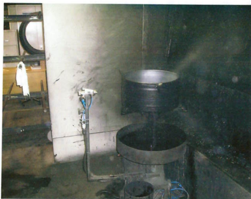
Figura 5 Aplicação de cola em carcaça de pneu, utilizando-se pistola de pintura tipo spray acoplada a sistema de ar comprimido com pressão controlada.
