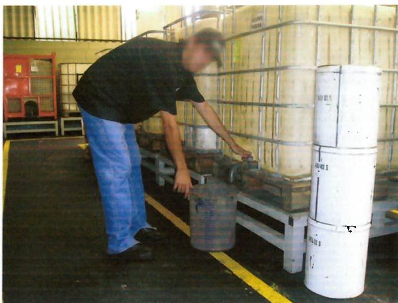
Figura 29 Coleta de solvente feita pelo funcionário, sem a utilização dos Equipamentos de Proteção Individual.
